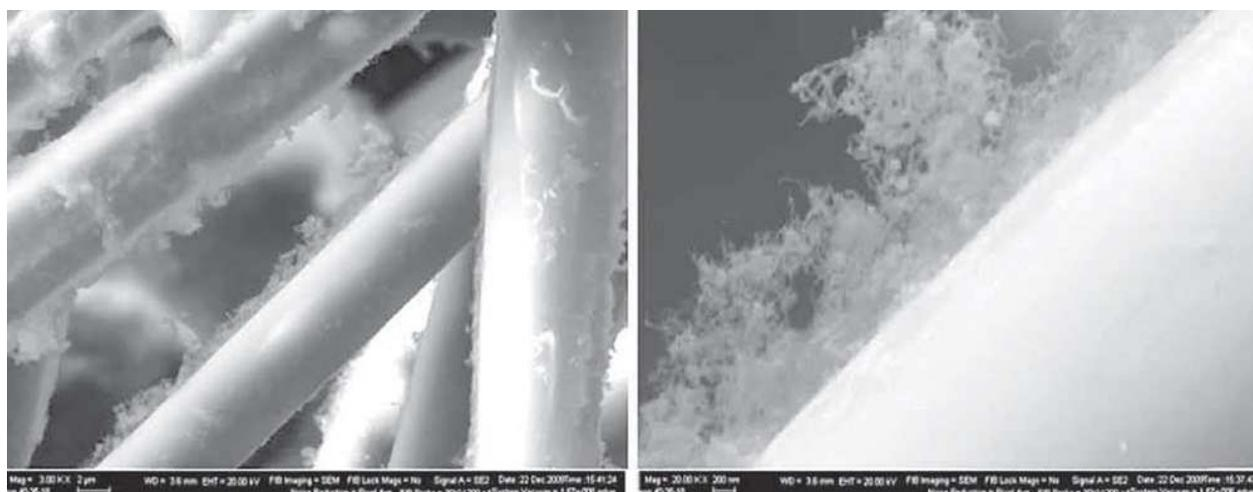
Рис. 2. Кремнеземные волокна фильтра, покрытые слоем УНТ
